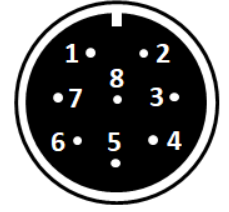
M12 / 8 Pin dişi soket (kablo takılan soketin karşıdan görünümü)
